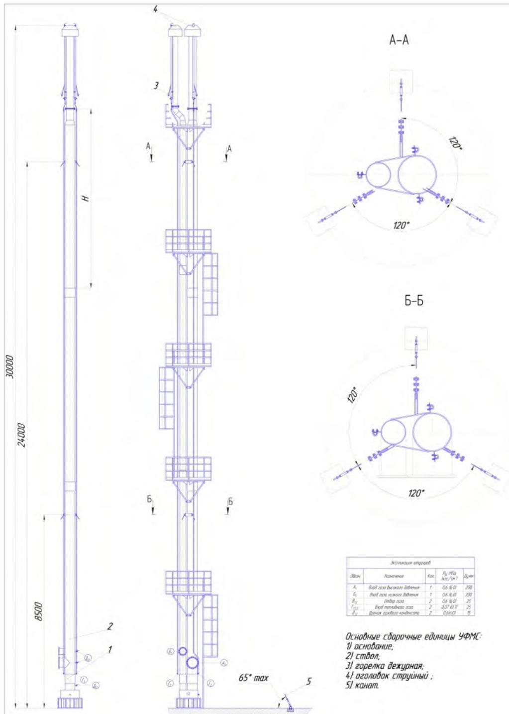
Габаритный чертеж УФМС с одним оголовком.
