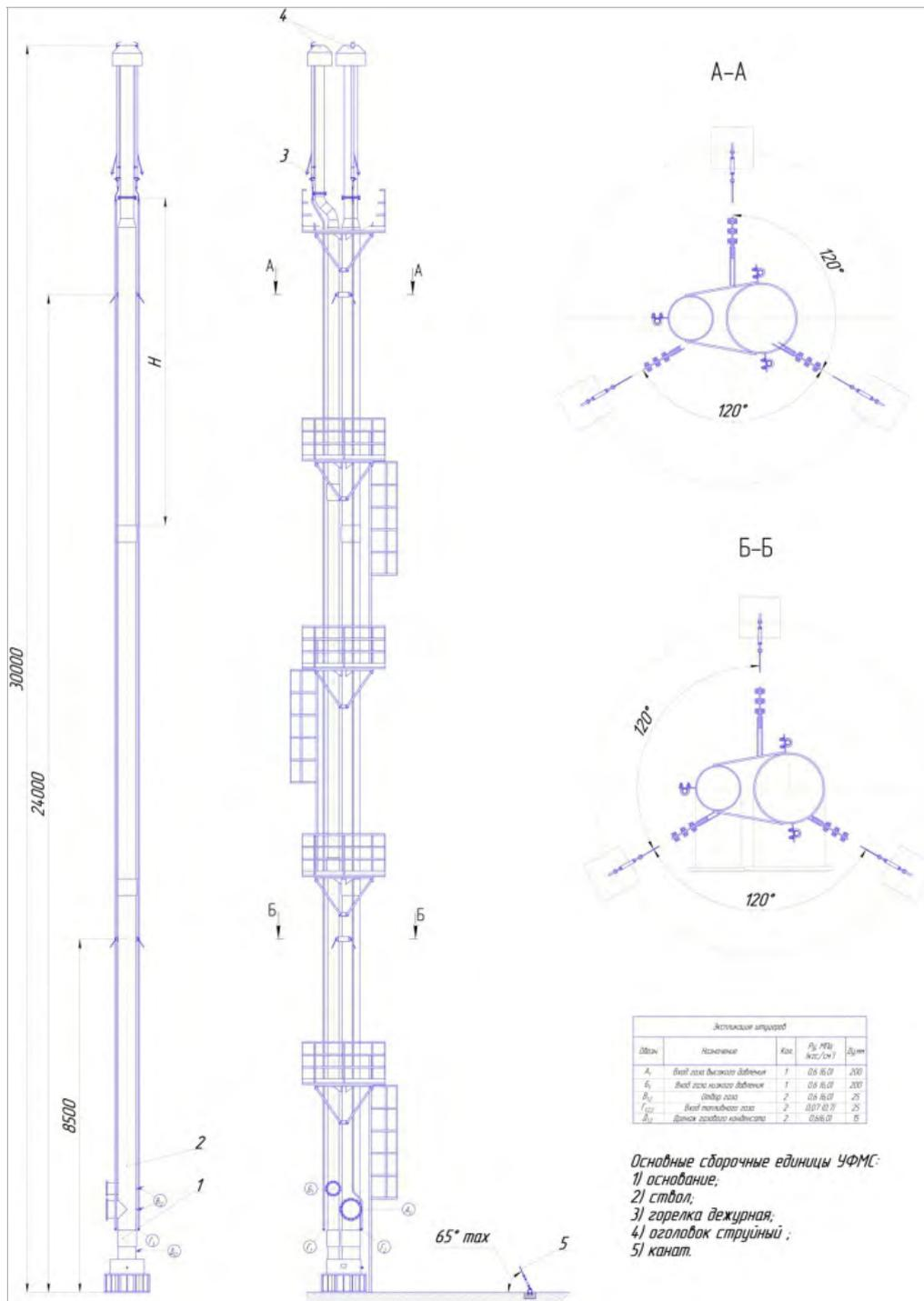
Габаритный чертеж УФМС с двумя оголовками.
